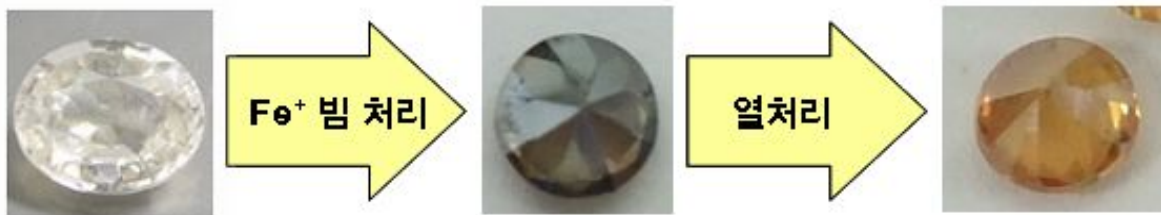
<그림 3.2.94 90keV \text{Fe}^+ 을 1.6 \times 10^{17}/\text{cm}^2 로 사파이어에 조사 후 열처리 전후 발색 변화>
