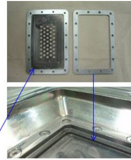
Grid 부 스페이서(4mm) 장착 (내부 간격은 기존과 동일)
