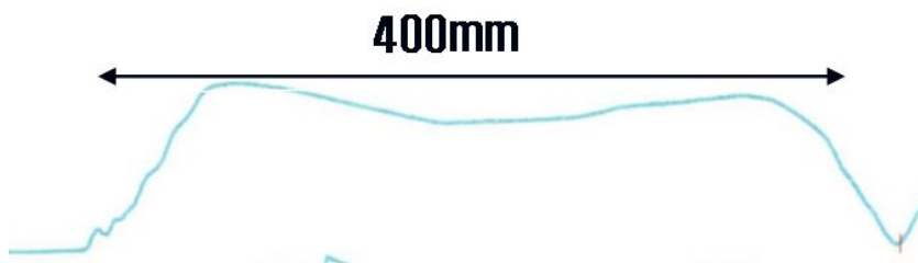
<그림 3.2.42 아르곤이온빔 프로파일 (3keV, 4mA( 1.8\mu\text{A}/\text{cm}^2 ))>
