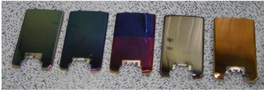
<그림 3.2.28 Mg 합금위에 증착된 Fe 2 O 3 의 두께에 따른 다양한 색상들>
