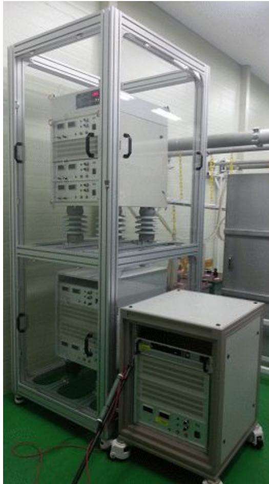
<그림 3.2.145 설치 완료된 전원 Rack 및 알루미늄 플로파일>
