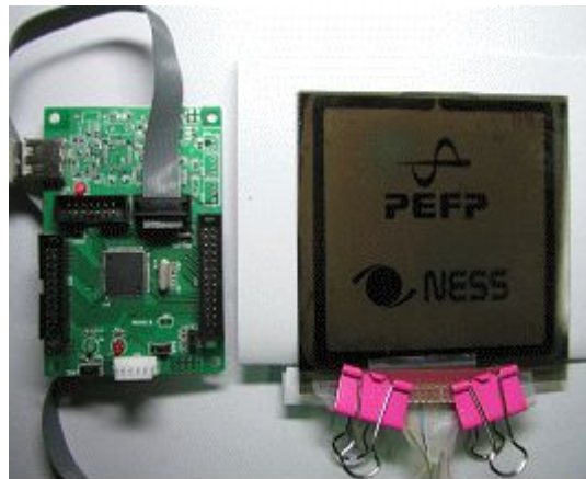
<그림 3.2.51 구동회로를 통한 전체화면 동작>
