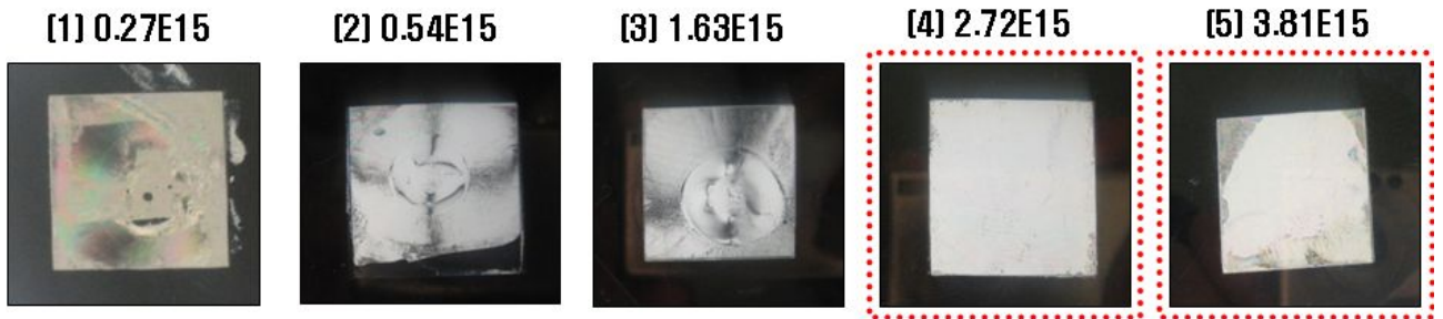
<그림 3.2.35 아르곤 이온빔 조사량에 따른 액정배향 시험>
