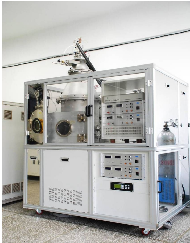
<그림 3.2.32 이온빔배향법에 사용된 이온빔장치>
