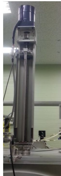
<그림 3.2.118 페러데이컵 설계 개념도 및 설치모습>
