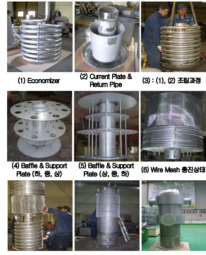
<그림 1.1-12(b) 대용량 콜드트랩 제작>
