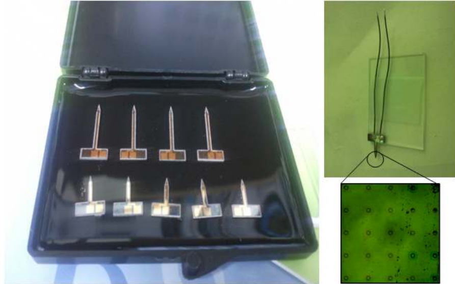
그림 27. MEMS을 이용하여 제작된 전기화학적 탐침형 뇌센서의 사진
