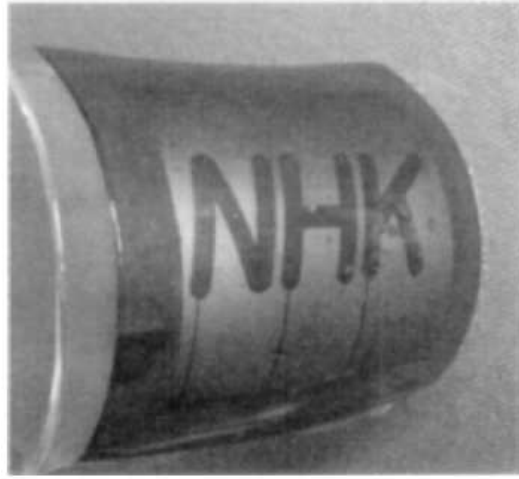
(그림 2-2-3) PSFLC를 적용한 플렉서블 디스플레이
