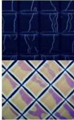
(그림 3-2-28) EHA 경화제를 사용한 액정 고분자 복합체 편광 현미경 사진
