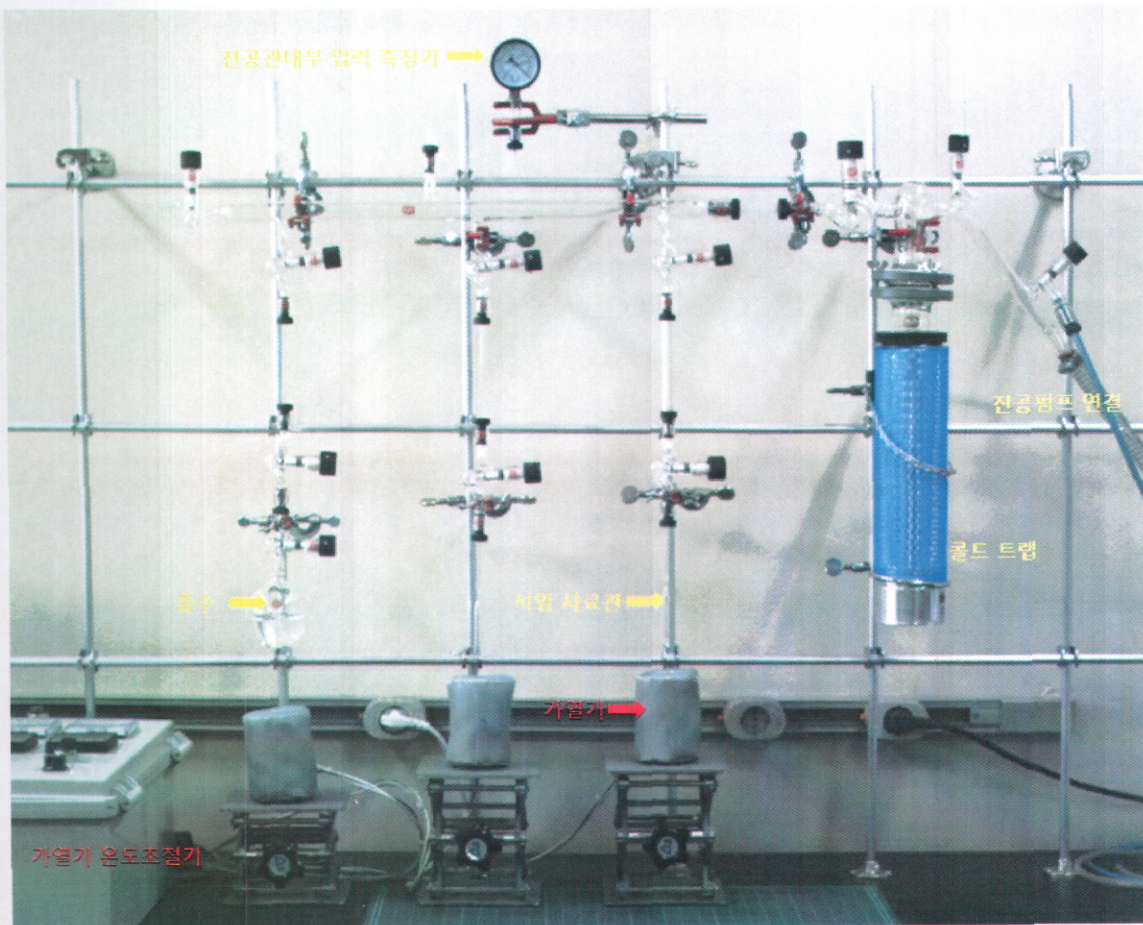
<그림 2> 본 실험을 위해 설계, 제작된 중수 치환용 진공관라인
