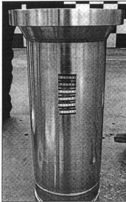
그림 3.28. KT500A 2차 1m 수평 봉위 낙하시험. 크레인 장착 모습(좌), 낙하 후 모습(우)
