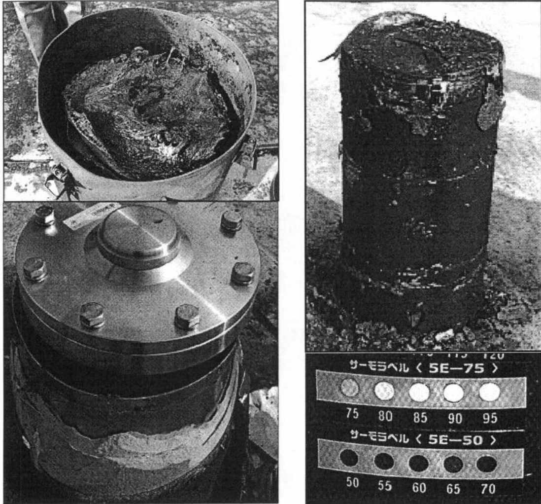
그림 3.31. KT500A 열시험 후 드럼 개봉 후 모습(좌상), 드럼을 제거한 모습(우상), 3M 단열재를 제거하는 모습(좌하) 및 저장용기 온도 표지 변색 모습
