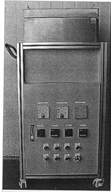
그림 2.4.7. 수소화물 Ti의 발화점 확인 실험을 위한 실험 장치 [Dimension: 500mm(W) x 700mm(L) 1267mm(H)]
