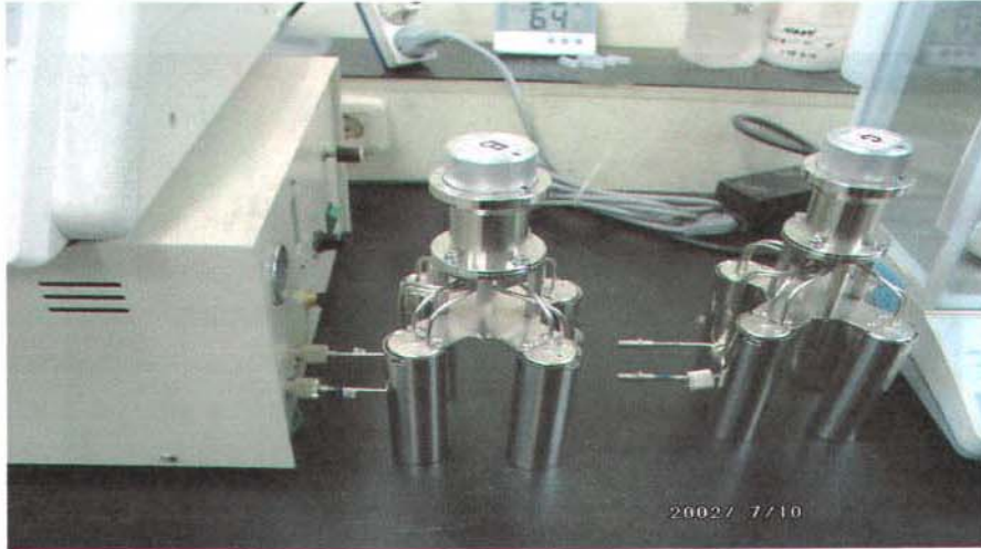
그림 199. 가스 크로마토그래프를 이용한 수소함량 측정
