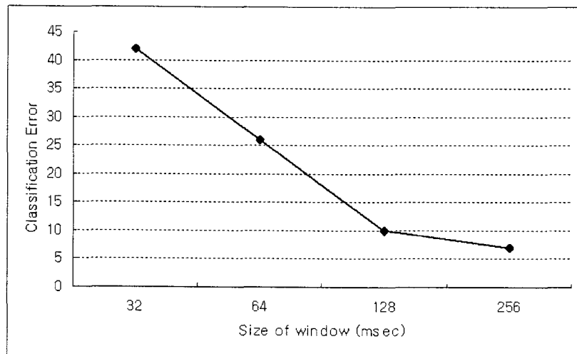
그림 3.2.2.92. Sliding Window의 크기에 따른 기본 동작 분류 에러 (참고: 최적의 sliding window의 크기를 정하기 위해 사용한 기본동작은 그림 3.2.2.96임)
