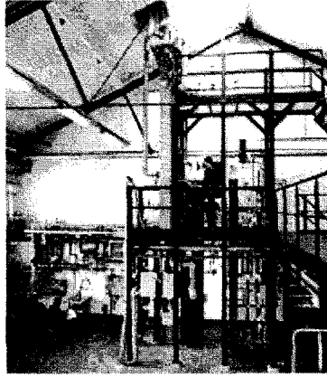
Figure 2.1.3. Haldor-Topsoe사의 50kg/day DME 제조 장치.
