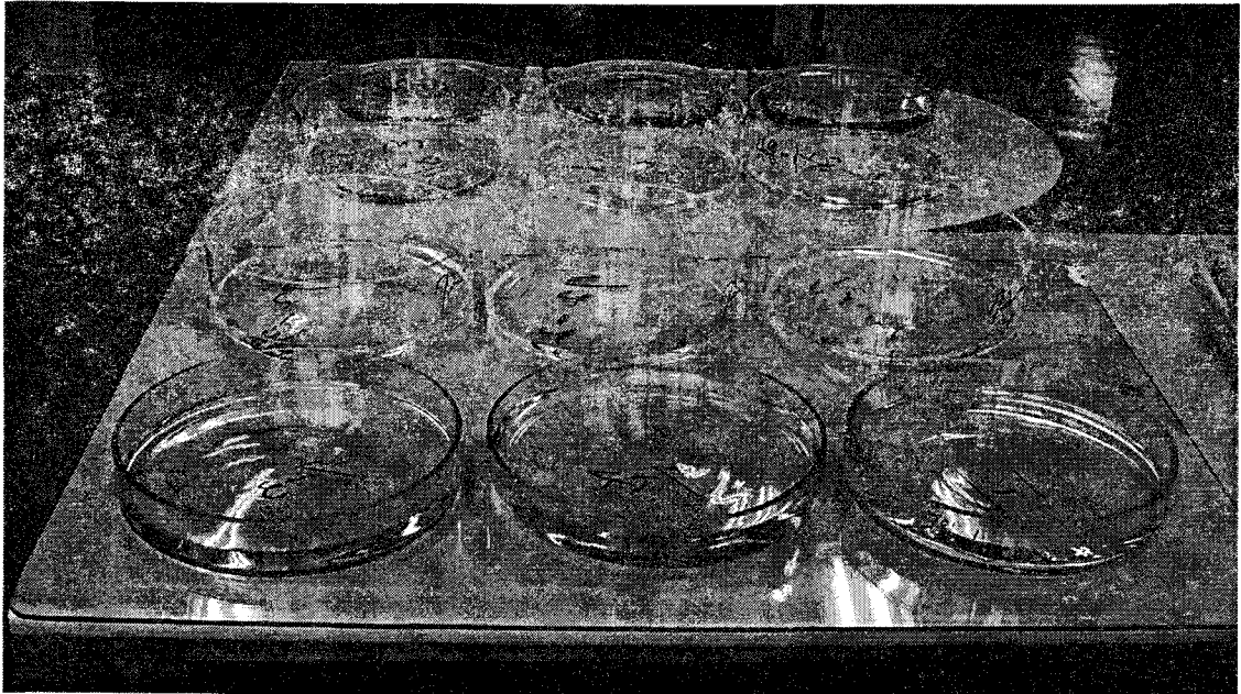
그림 3.A.4. 수침적판 실내 실험 모습. 현장 실험에서와 같이 3개씩을 한 조로 하여 한 조는 매일 침적량을 측정하는데 비하여 다른 조는 일주일 후에 침적을 측정하는 등 침적 시간에 따른 침적량을 비교.
