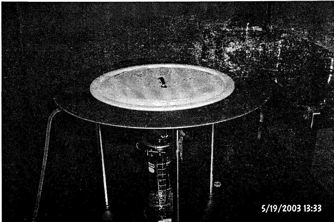
그림 3.A.7. WSS와 수침적판의 비교 실험 모습. POM으로 WSS의 침적판을 다시 제작하였고 당초 아래 금속 상자 안에 있었던 침적수 저장조를 위로 올려 연결 부위를 줄임.
