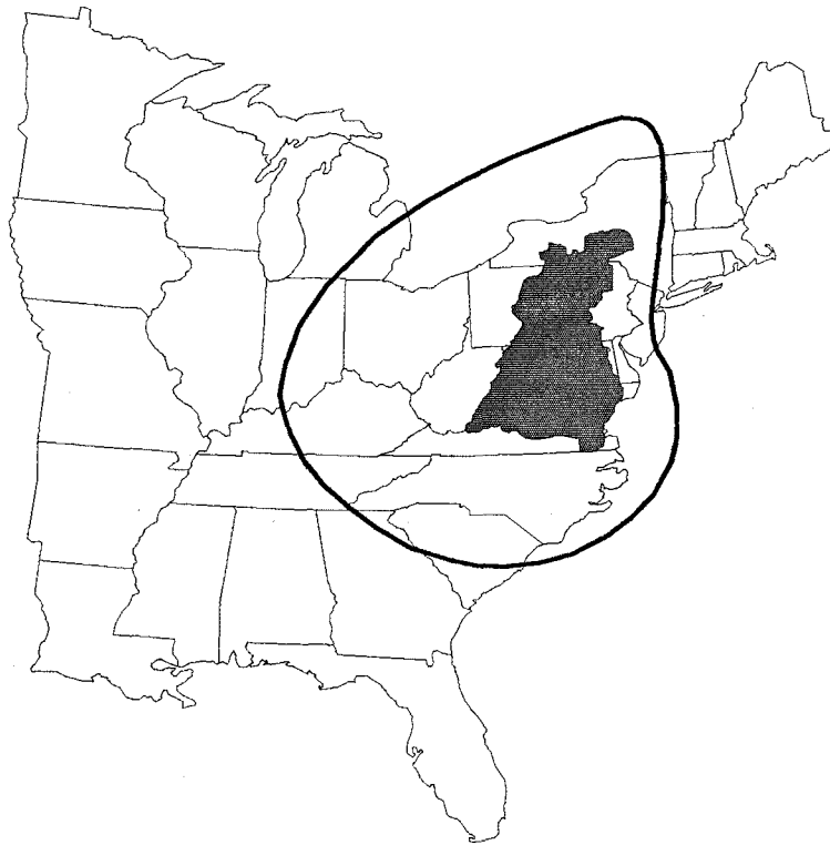
그림 2.3. 체사픽만의 수계와 대기계. 수계는 회색으로 음영 처리된 지역이며, 대기계는 폐곡선으로 표시. 당초 Dennis (1997)는 수계에 침적되는 산화 질소의 75%를 배출하는 지역을 대기계로 설정하였으나 76%를 보다 합당한 기준으로 생각하여 다시 계산 (USEPA, 2000; 표 2.5 참조).
