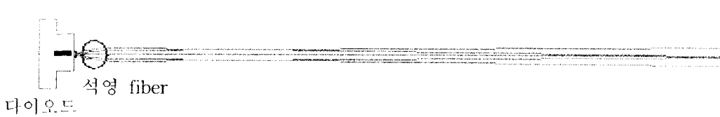
그림 6 석영 광섬유를 사용한 collimation
