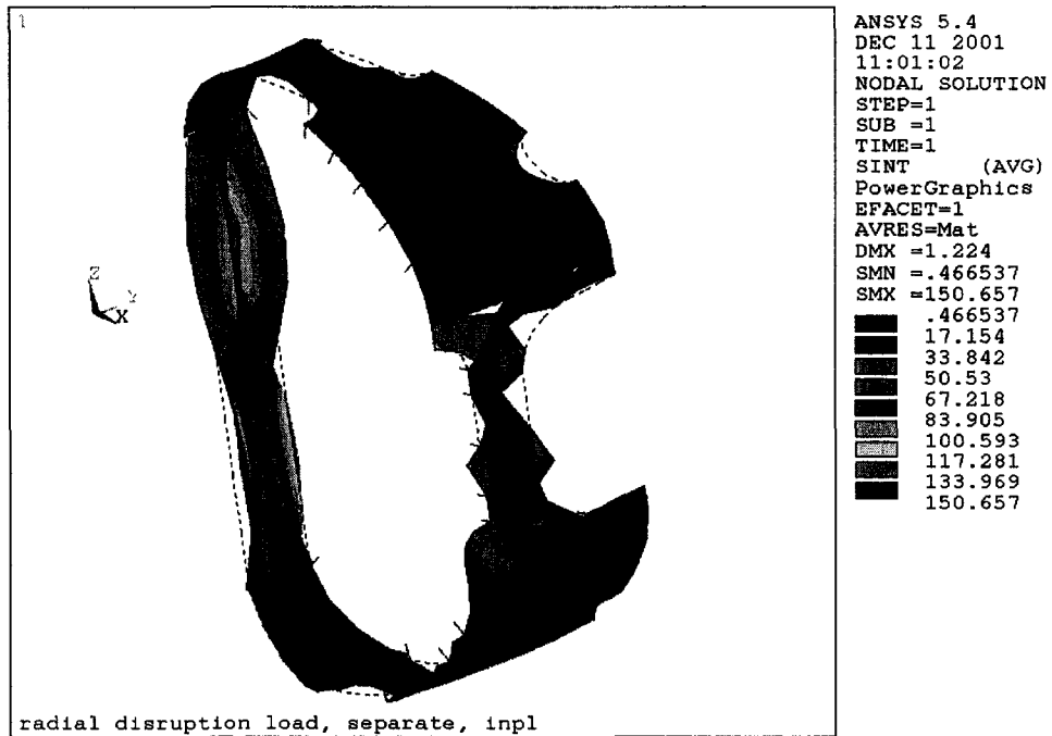
그림 3.5-7 참고문헌 [Ref. 3.5-3]의 경우와 같이 지지했을 때 결합모델에서 발생하는 응력분포
