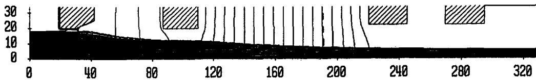
그림 3-1-15 밀도의 변화에 대응한 이온원의 운전 결과 (120 kV, \sigma = 0.2 \text{ A/cm}^2 , V_{PG}/V_{GG} = 0.85 )
