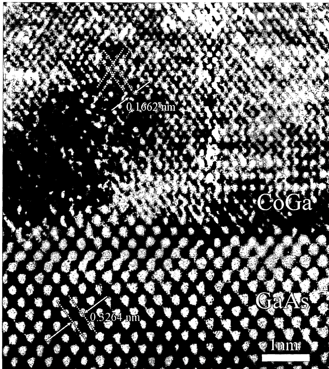
그림 3.2.24 [011] 방향으로 관찰한 CoGa/GaAs구조의 확대된 고분해능상. CoGa (111) 면간거리가 0.1662 nm로 매우 작으며 원자단위로의 분석이 가능하다
