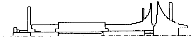
그림 3.6-3 Schematic of the mock-up APU rotor for model verification.
