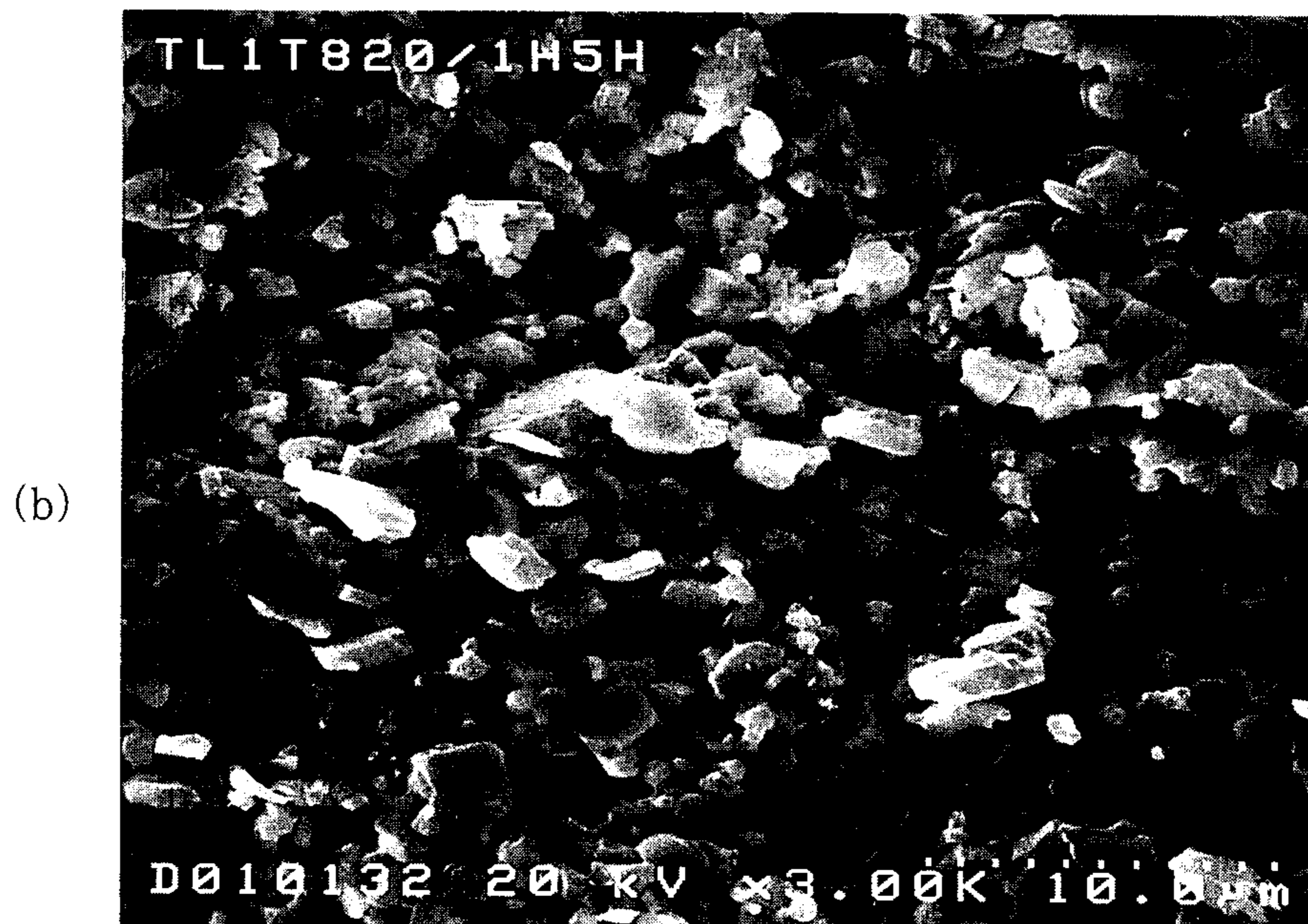
그림 6-3. y=0 명목조성의 선재를 (a) 810과 (b) 820, (c) 830, (d) 840°C에서 각각 1시간 열처리한 다음 압연하여 같은 온도에서 다시 5시간 열처리하여 제조한 선재의 코어 표면 SEM 사진.
