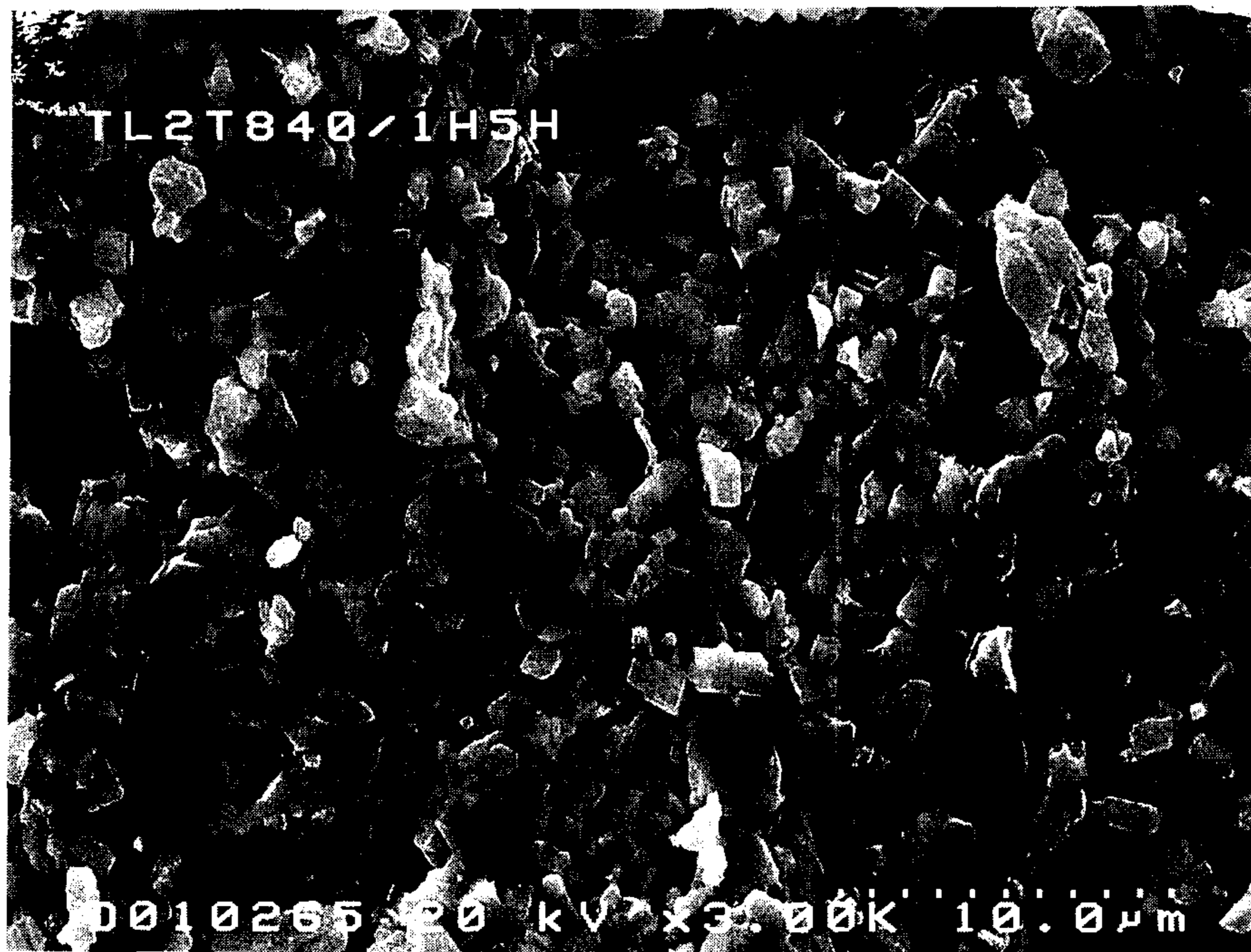
그림 6-5. 가장 높은 I_c 를 나타낸, 840 °C에서 1시간 열처리한 후 압연하여 다시 같은 온도에서 5시간 열처리하여 제조한 선재시편 코어단면의 SEM 사진.
