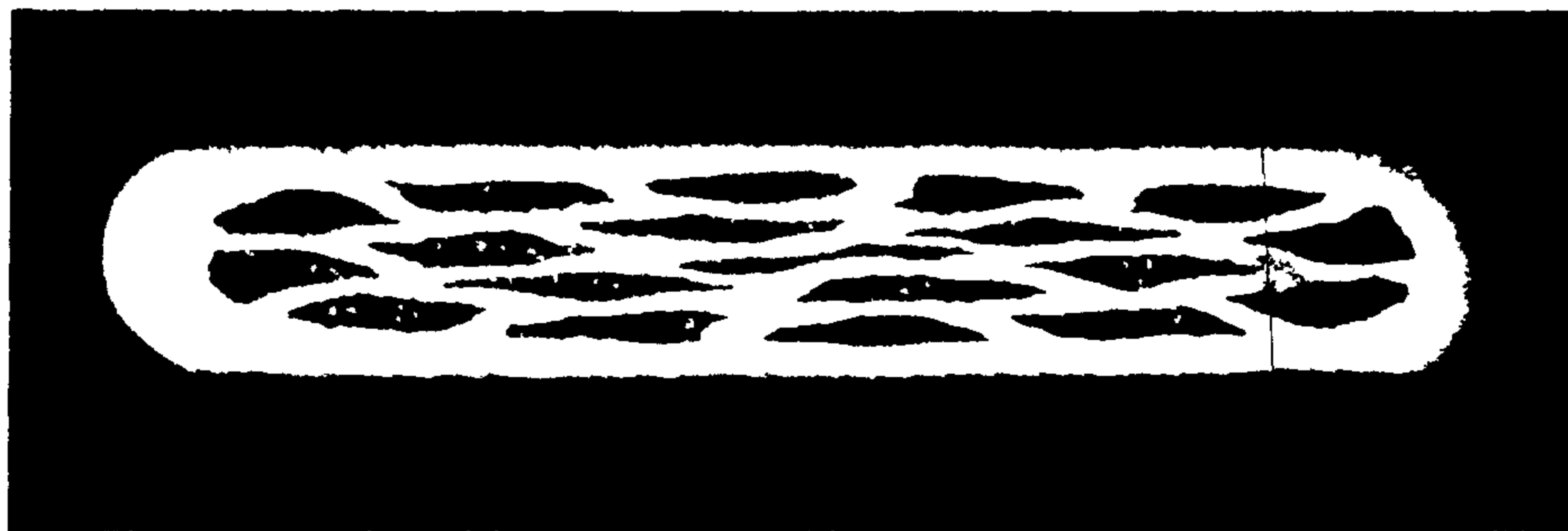
그림 6-3. 19심 고온초전도테이프의 가운데 부분의 단면. 두께 0.5mm
