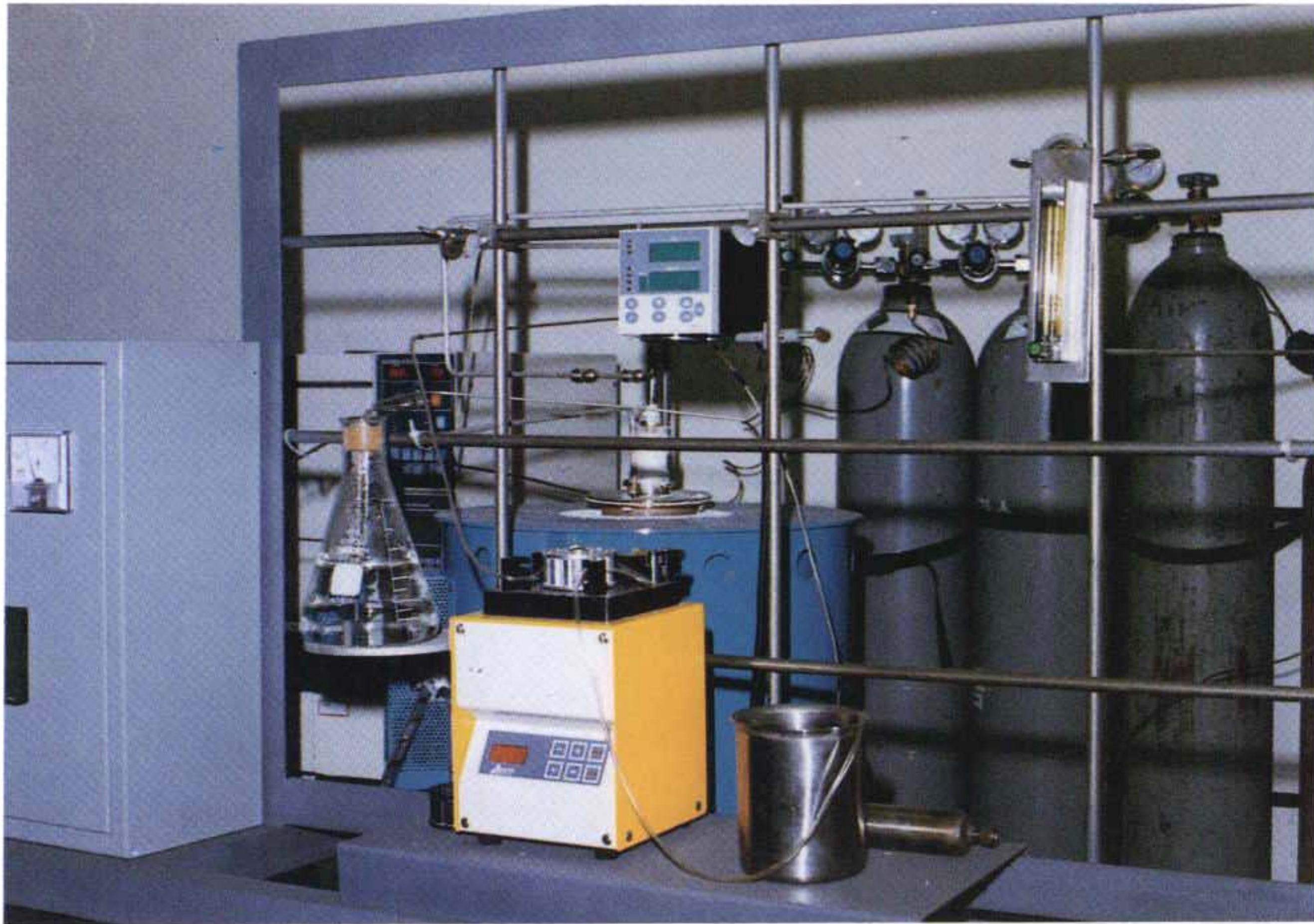
[그림 3-13] 실험실 규모의 MSD 실험 장치
