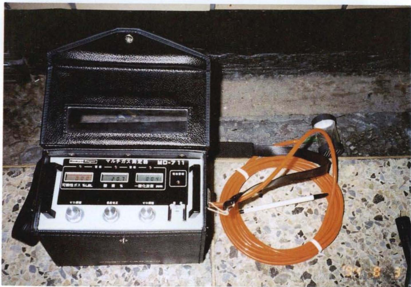
그림17. MD-711의 CO 및 산소 가스 농도 측정
