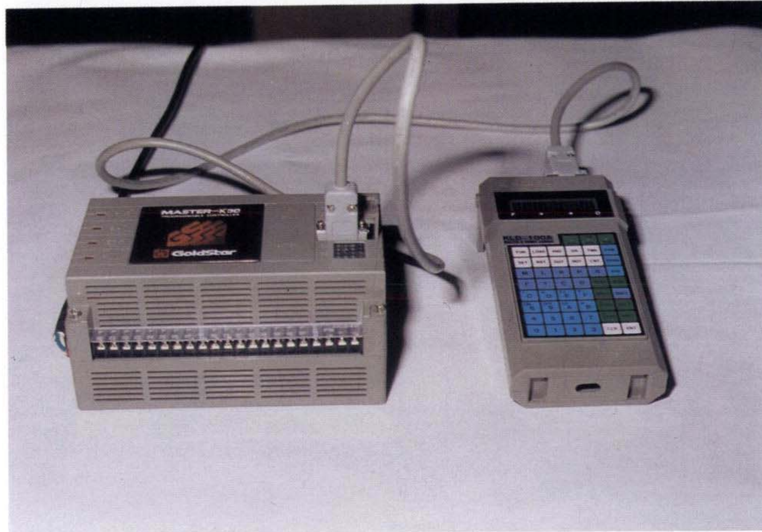
<사진 3-8> PLC 본체 와 handy loader
