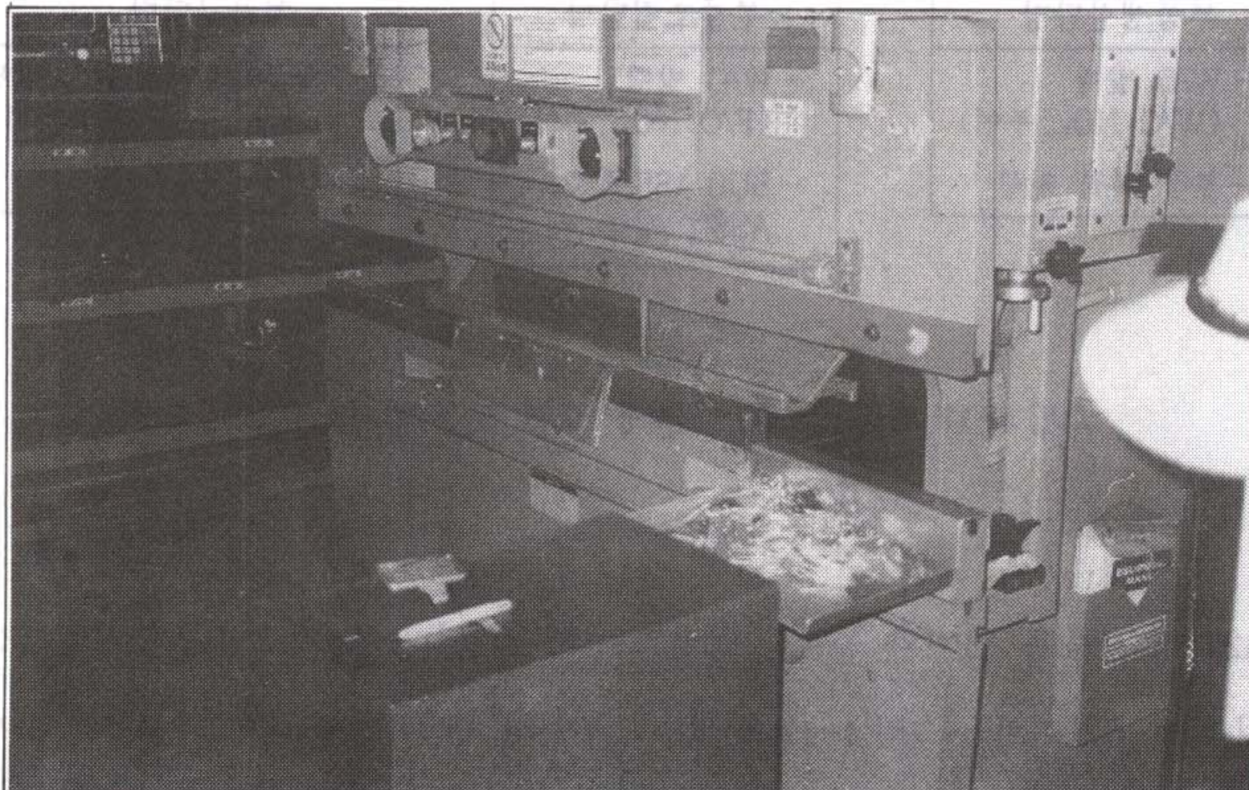
사진 4-24 Brake forming중인 부품
