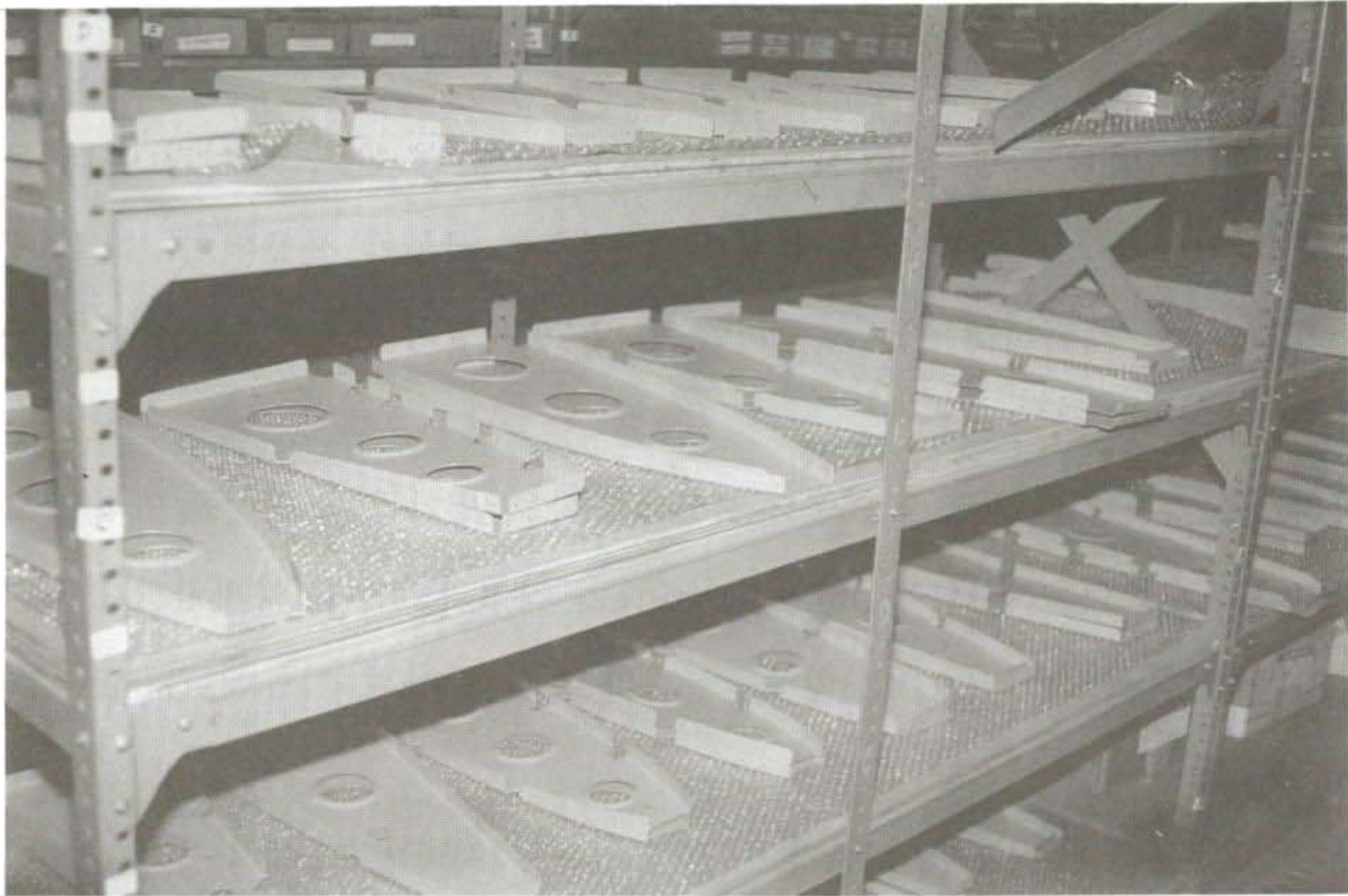
사진 4-24 Hydro-Forming된 리브 및 기타 부품류
