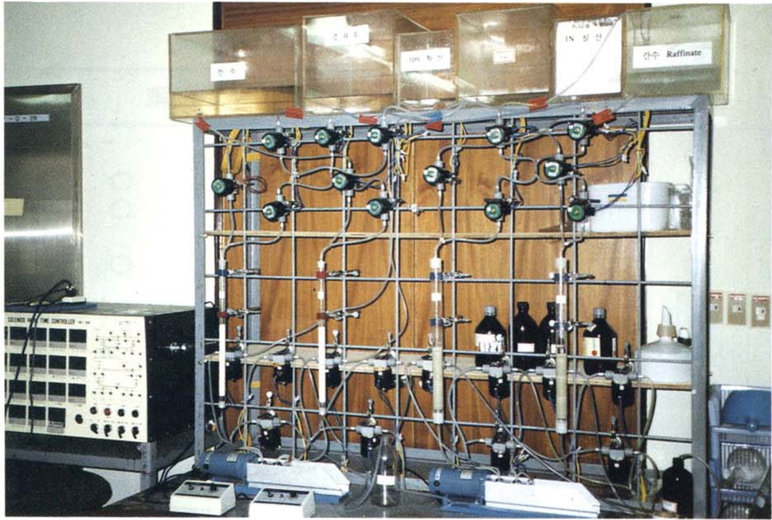
사진 5.1 간수로부터 붕소와 리튬을 회수하기 위한 이온교환컬럼 Scale-Up 장치의 Overview.
