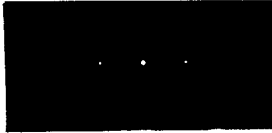
그림 3-14. 제작된 sinusoidal 회절격자의 Fourier 스펙트럼
