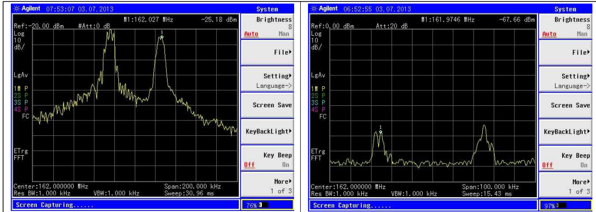
[그림 3-11] 161.9~162.1MHz 대역의 주파수 환경 측정결과(부산)
