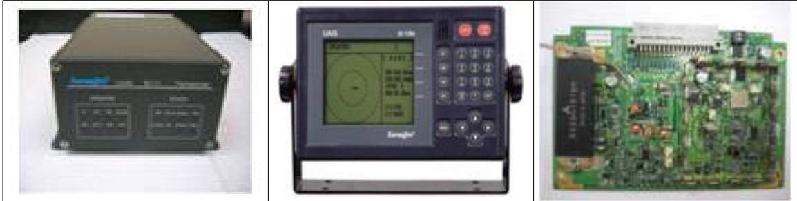
[그림 2-19] AIS Class A 장치 구성
