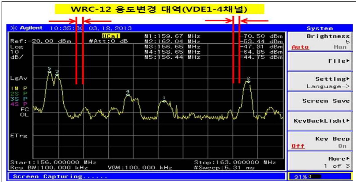
[그림 3-17] 156~163MHz 대역의 주파수 환경 측정결과(목포)
