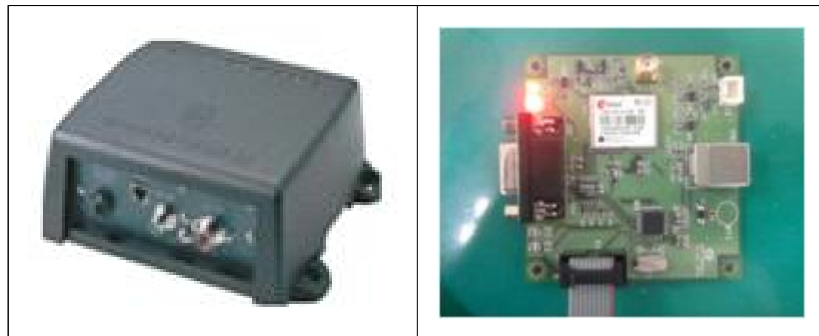
[그림 2-20] AIS Class B 장치 구성
