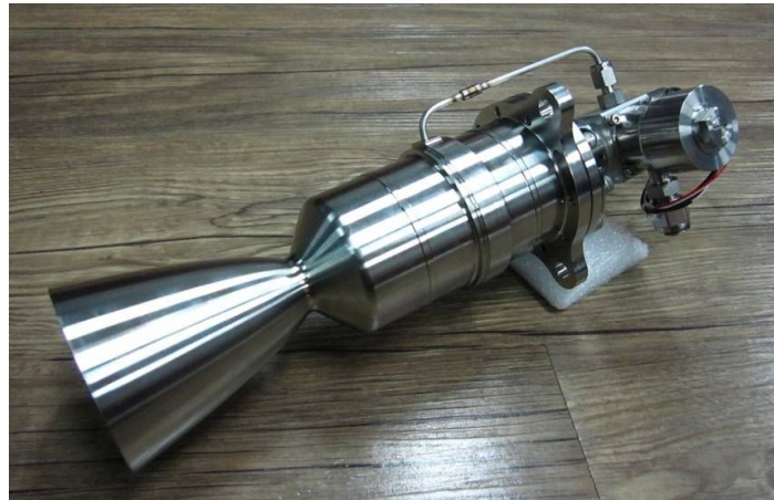
그림 3.15 탐사선용 1,200 N 급 이원추진제 로켓 엔진 비행 모델
