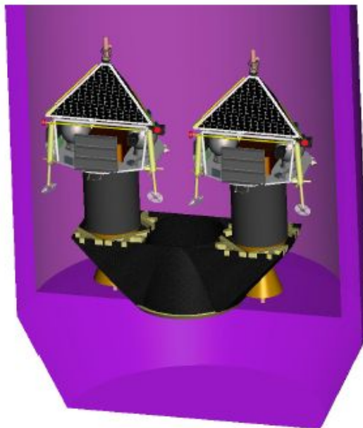
그림 5.7 태양전지 적용 달 착륙선을 Falcon 9 발사체에 탑재한 형상
