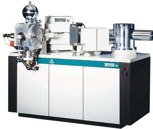
그림3.7 한국지질자원연구원이 정밀 동위원소비 측정을 통해 행성시료의 연대측정 수행하기 위해 도입예정인 열이온화 질량분석기 ⇒ 각국의 시료귀환계획에 참여하기 위해서는 이외에 다양한 질량분석기를 통합한 종합 분석시스템의 구축이 필요함
