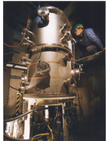
그림 16. Argonne 과 commonwealth가 개발하고 있는 플라이휠 에너지 저장장치.
