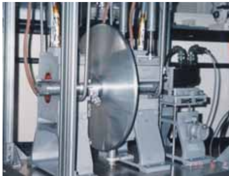
그림 5. 전력연구원이 개발한 7 Wh급 수평축 초전도 플라이휠 에너지저장장치
