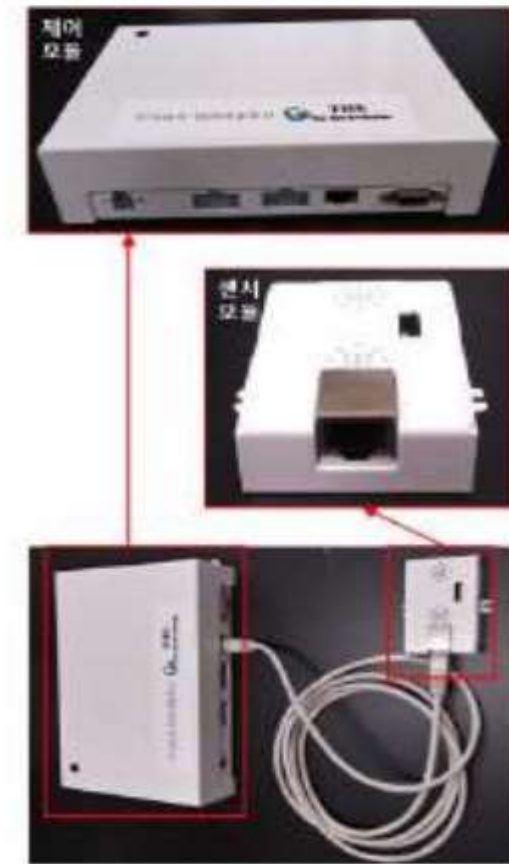
[그림 1-37] ESS 오프가스 감지장비 시제품
