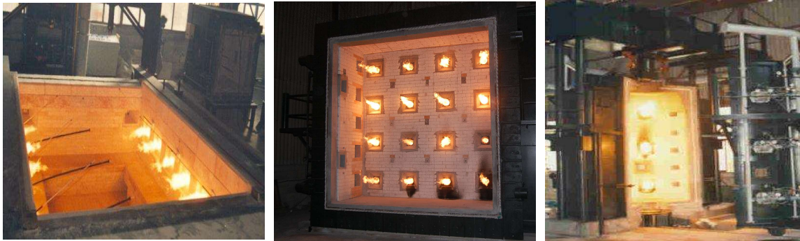
[그림 2-66] 방화구획 구조부재의 화재안전성능 검증 실험
