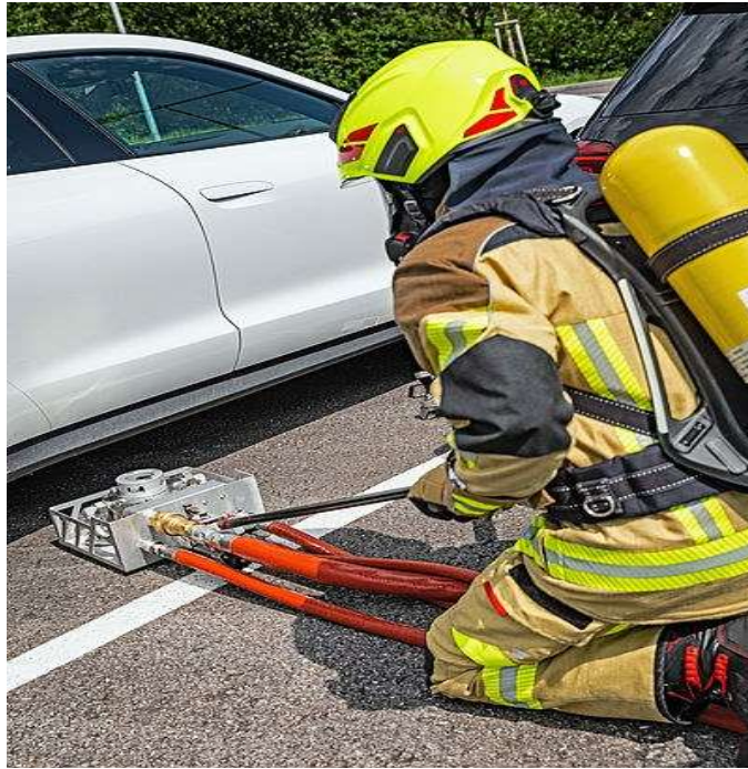
[그림 1-32] Rosenbauer의 배터리 직접 냉각시스템
