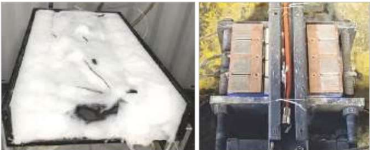
[그림 1-39] 압축공기포 점착 형상(좌) 및 열감응튜브 적용 형상(우)
