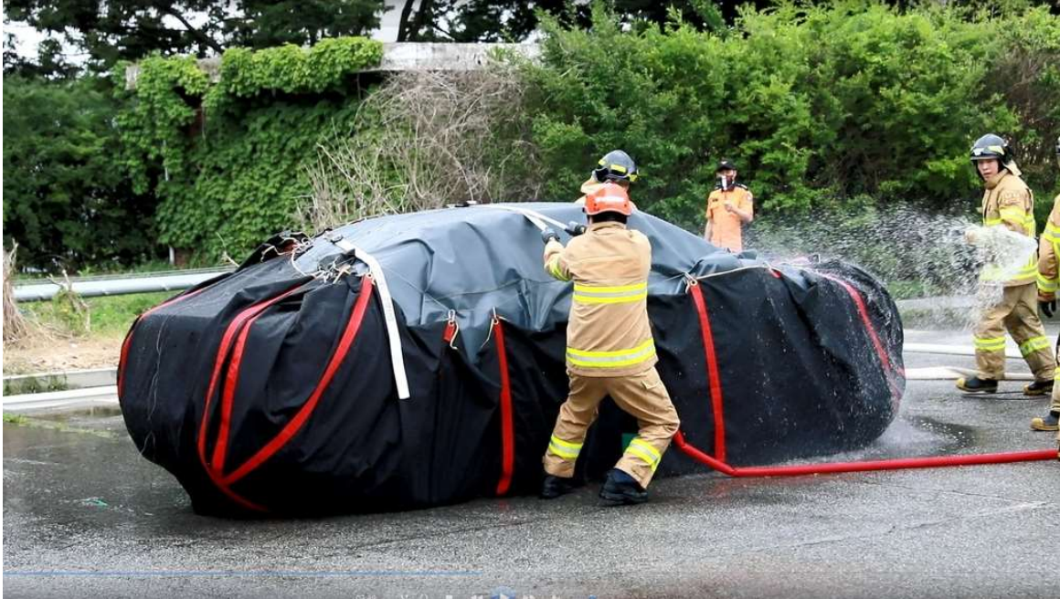
[그림 1-40] 질식소화포와 와이어를 이용한 전기차 화재 진압 기술
