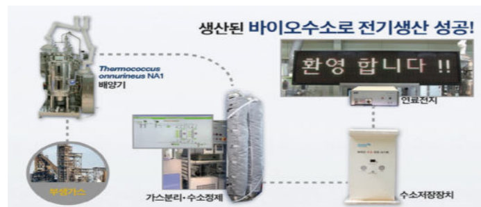
제철소 일산화탄소 포함 부생가스를 활용한 바이오 수소 생산과 이를 활용한 전기 생산 개념도. * 출처: 연구자 제공
