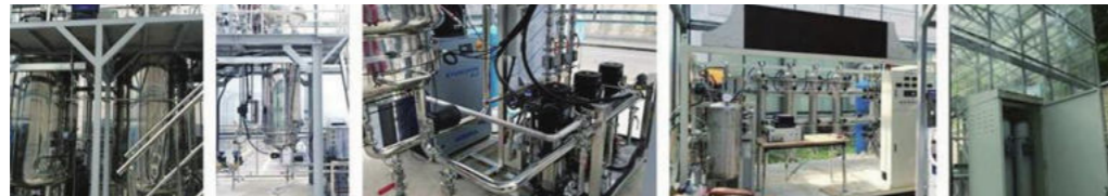
바이오 수소 생산을 위한 장치들. 피드 탱크, 1배양기, 마이크로버블러, PSA수소정제장치, 수소저장장치(왼쪽부터) * 출처: 연구자 제공
