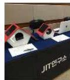
마을전산실 - 새집형 구조물에 라즈베리파이 컴퓨터와 백업배터리, 전원장치 및 IP카메라 내장. 센터 내에 설치
